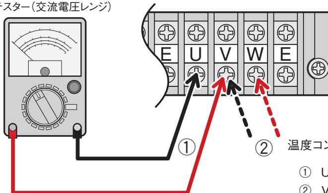
温度コントローラーの出力中 (OUT表示の時に)
