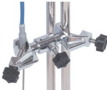
**⚠ 注意** 工具を使って強く締め付けると、ヒーターパイプおよび熱電対スリーブを破損する恐れがありますので、おやめください。
