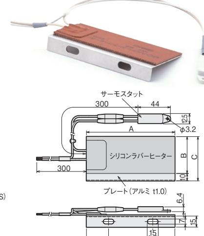
(注) サーモスタッフは、シリコンラバーヒーターの熱影響を直接受けない場所に設置してください。
