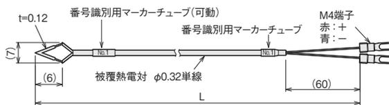
被覆熱電対 : フッ素樹脂 (FEP) 被覆 / ガラス編組被覆 φ0.32単線
