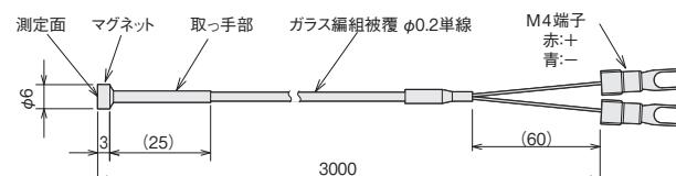
熱電対タイプ : K タイプ ガラス編組被覆  $\phi 0.2$  単線
