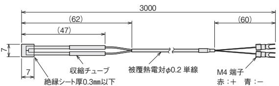
先端部分がシート状のKタイプ熱電対です。測定範囲は180°Cまで、応答性が優れています。非常に薄いため、電子回路の半導体素子やチップなど、スペースがないところに貼り付けるのに最適です。
