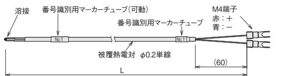
被覆熱電対 : フッ素樹脂(FEP)被覆／ガラス編組被覆 φ0.2単線
