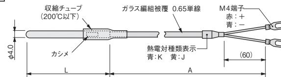
被覆熱電対種類 : ガラス編組被覆  $\phi 0.65$  単線
