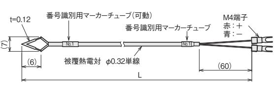
被覆熱電対 : フッ素樹脂(FEP)被覆／ガラス編組被覆 φ0.32単線
