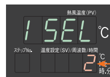
「2」で外部温度センサー熱電対で制御
