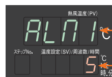
温度调节异常 1 的警报类型：对应本体出风口处的热电偶
