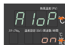
温度调节异常 1 的自动保持设定 对应本体出风口的热电偶
