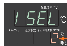
「2」で外部温度センサー熱電対で制御
