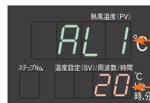
温度調節異常 1 の動作値設定 本体吐出口の熱電対に対応 初期値「20」
