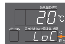
キーロックが設定された状態で設定を行うおうとした場合、△▽キーを押している間「LoC」を表示します
