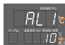
温度調節異常1の動作値設定 管体出口の熱電対に対応 初期値「10」
