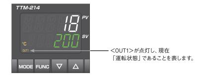
現在温度が設定温度より高い場合 「待機状態」から「運転状態」に切替えても、ヒーターへは通電されません。その場合<OUT1>は点灯しません。
