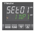
(2) アップキー △ またはダウンキー ▽ を押し、 (2) アップキー △ またはダウンキー ▽ を押 出力3種類設定(SET07)を表示させます。
