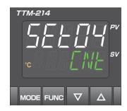
(4) モードキー MODE を数回押し、AT 起動画面を表示 させます。
