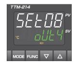
(3) モードキー wore を数回押して、out4 種類設定 (E4H) を表示させます。
