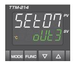
(3) モードキー MODE を数回押して、out3 種類設定 (E3H) を表示させます。
