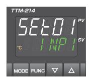
(3) アップキー △ またはダウンキー ▽ を押 し、制御設定モード(SET04) を表示させます。
