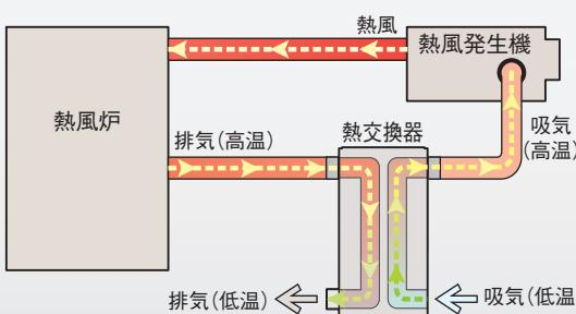
熱交換器を使えば、熱だけ回収し再利用！
