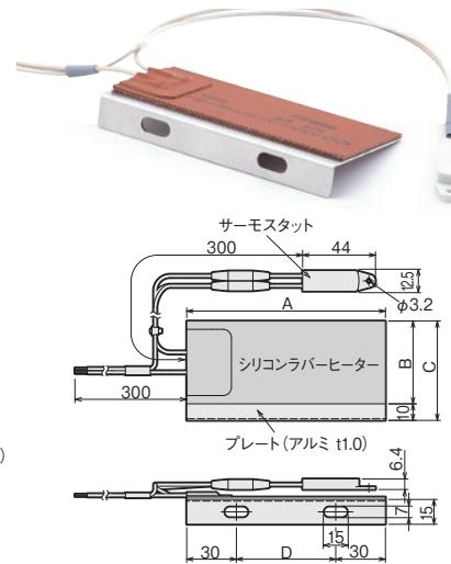
(注) サーモスタッフは、シリコンラバーヒーターの熱影響を直接受けない場所に設置してください。
