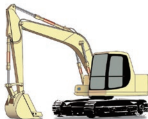
寒冷地建設機械 油圧シリンダー保温用
