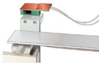
冷蔵庫内光電センサー霜取り用
