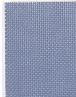
ロスナボードに匹敵する、耐熱性、圧縮クリープ特性を持ちながら絶縁性を重視した材料です。
