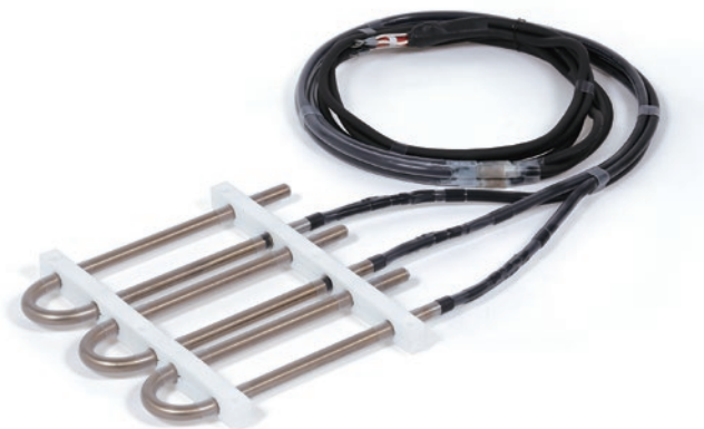
ヒーターシース：SUS304+フッ素樹脂0.3mm (PFA) 電源電線：3芯PVCコード3本（端子側で三相に結線）
