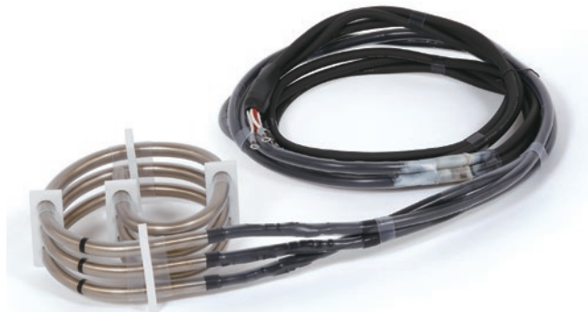
ヒーターシース：SUS304+フッ素樹脂0.3mm (PFA) 電源電線：3芯PVCコード3本（端子側で三相に結線）
