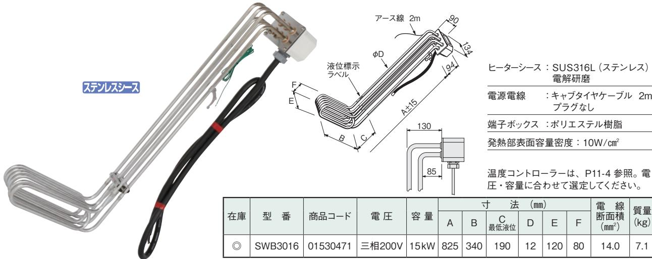
ヒーターシース : SUS316L (ステンレス) 電解研磨
