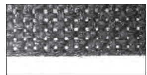
ヒートカットによる切断 切断面が溶けてぼつれない
