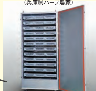
熱源 熱風発生機 1台 処理量 30kg
