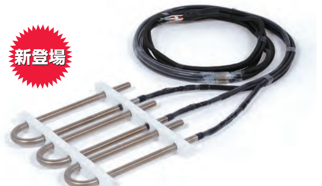
ヒーターシース：SUS304+フッ素樹脂0.3mm (PFA) 電源電線：3芯PVCコード3本（端子側で三相に結線）
