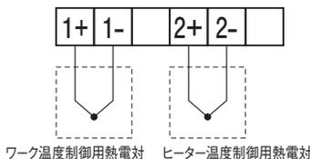
各温度調節器の制御出力がともにONの場合、ヒーター出力を行います。
