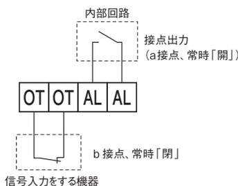
警報動作: 出力遮断、表示灯点灯、外部警報出力 ON (接点「閉」)
