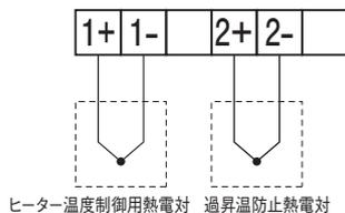
・過昇温防止用熱電対で検知した温度が過昇温防止用温度調節器に設定した値を超えると警報動作となります。
