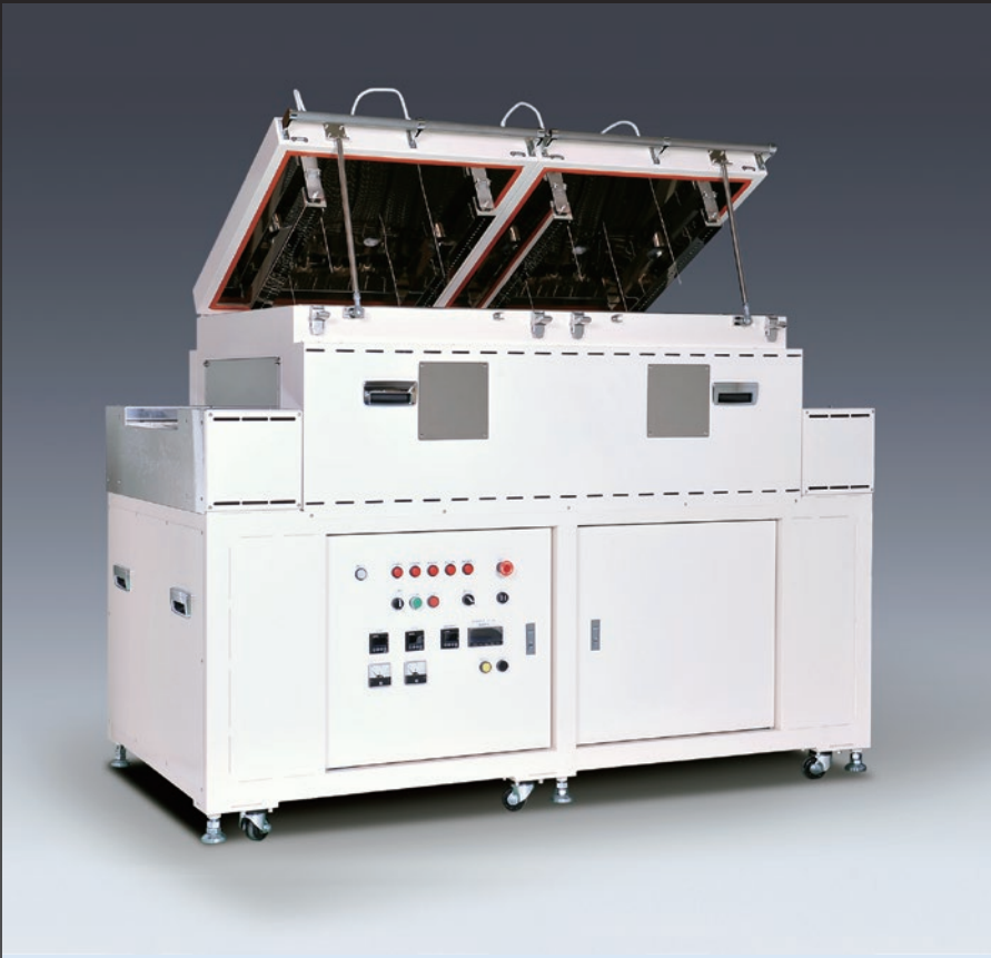
コンベア型遠赤・熱風併用炉 (テスト炉)
