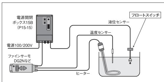
電源開閉ボックス31B/50B、八光温調付きヒーターとフロートスイッチを組み合わせて使用する場合
