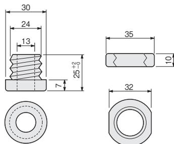
フィンヒーター、棒ヒーターおよび電熱線ヒーターなどの支持碍子です。材質もムライトで高温の所で十分使用でき、ねじ式ですので取付作業が簡単です。
