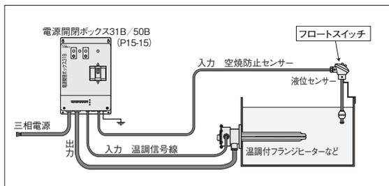
サーモシリーズ、投込みヒーターとフロートスイッチを組み合わせて使用する場合
