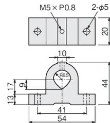
フィンヒーター・棒ヒーターの支持碍子です。M5のねじをつければφ8からφ12までのヒーターを押さえられます。
