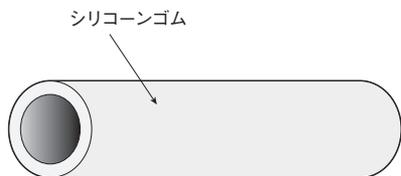
STシリーズは、加熱により簡単に内径が約1/2に収縮する熱収縮ゴムチューブです。耐熱・耐寒性、耐候性、電気特性などを必要とする個所の被覆に使用されています。
