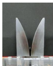
図2. グライディングアーク放電実験装置の電極
