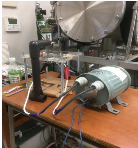
図 5. グライディングアーク放電実験装置の外観写真
