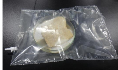
図 26. サンゴを用いた CO 2 発生試験
