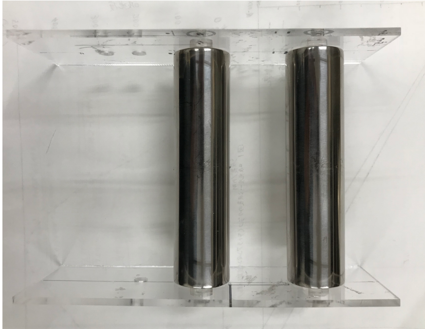
Fig.2 製作した格子型マグネットバー
