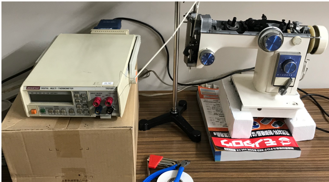
Fig.1 製作した上下運動機構を持つ装置 (右) とデジタルマルチメーター (左)
