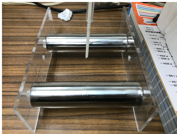
Fig. 2 格子型マグネットバーと熱電対
