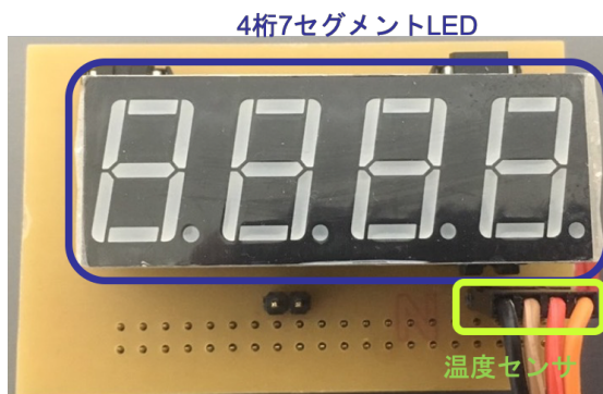
図 2 温度取得システムの回路パターン
