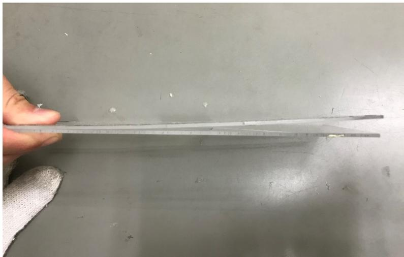
図 8 アクリル板 (上：変形後 下：変形前)
