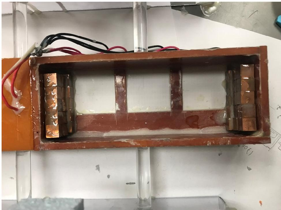
図 7 はめ込み型 熱電変換素子×3
