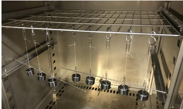
図 7 オープンで熱処理している様子
