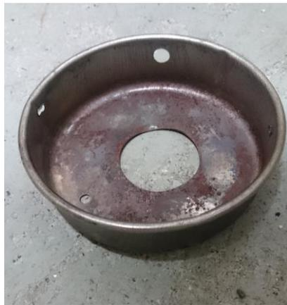
Fig.4 ロケットストーブ吸気側に取り付ける蓋
