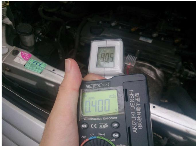
図7 ペルチェ素子を貼り付けて発電効果の確認
