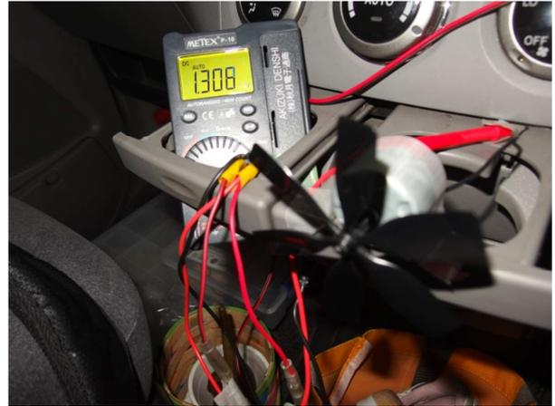
図9 モーターとプロペラファンの外観（左），車内でのプロペラファンの動作実験（右）
