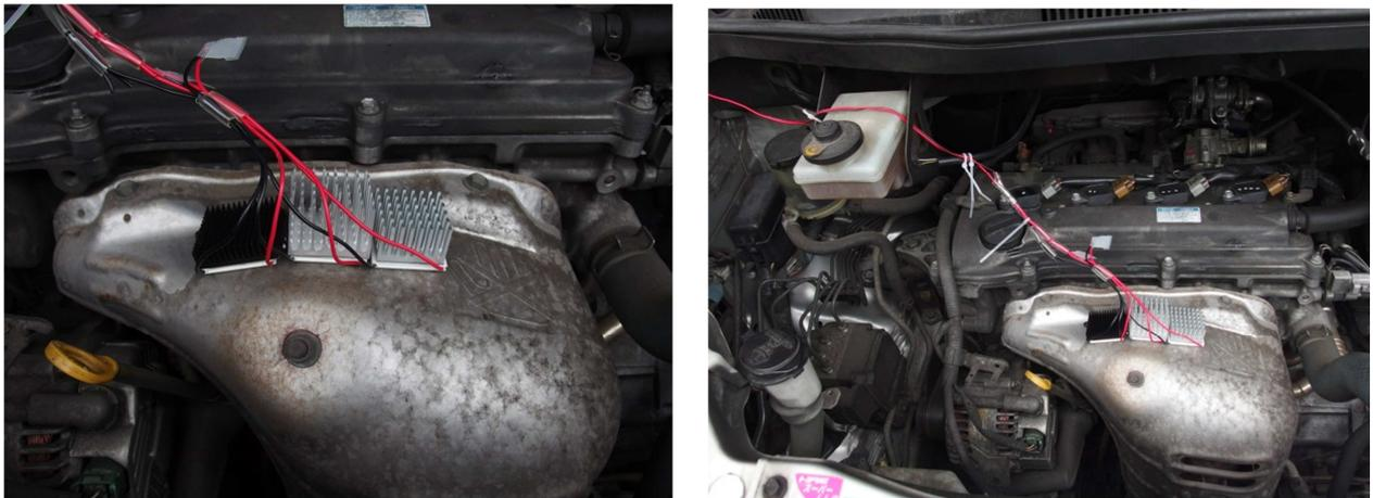
図 8 エンジンの排気カバーにペルチェ素子 3 枚を貼り付けた状態
