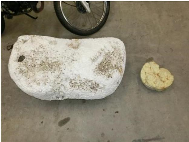
図 8 溶解前のフロートと溶解後に成形した状態
