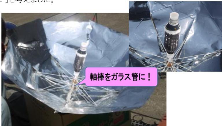
写真1 H27年度製作 パラボラ型ソーラークッカー
