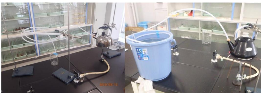
写真2 製作した冷却器とやかん蒸留器
