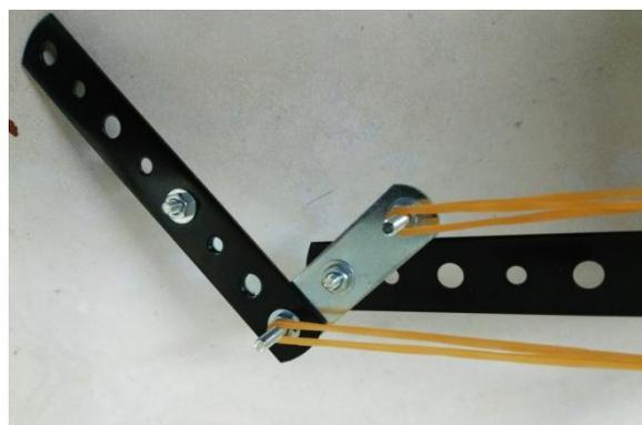
Fig. 6. 関節部分の構造
