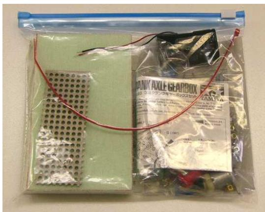
図3 試作した魚ロボット教材の配布状態（乾電池タイプ）
