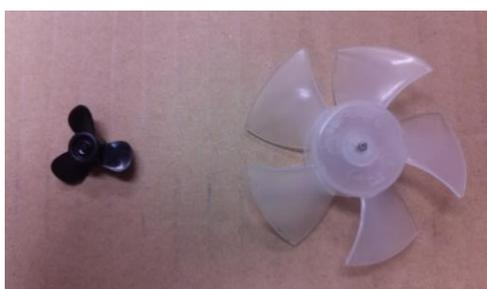
Fig.14 スクリュー (左 : 直径 2.5cm, 右 : 直径 6cm)
