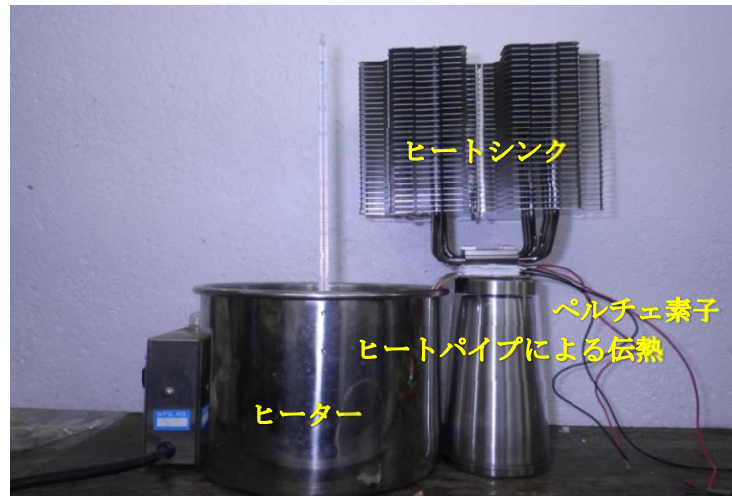
図 11 ペルチェ素子による発電システム
