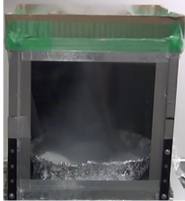
図 18: 塵旋風が発生している図
