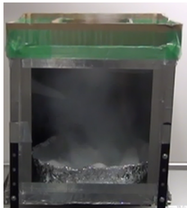
図 19: L_1, L_2 大きくして塵旋風が発生している図
