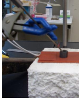
図3 フェライト (10×6.1×10) での磁束密度測定の様子
