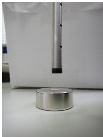
図 14 磁束密度の測定
