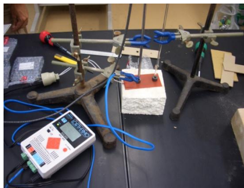
図3 フェライト (10×6.1×10) での磁束密度測定の様子
