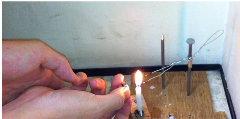
図 6: 針金の一端が永久磁石に引き付けられる様子
