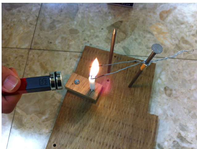
図 4: キュリー点を利用した針金の消磁実験機
