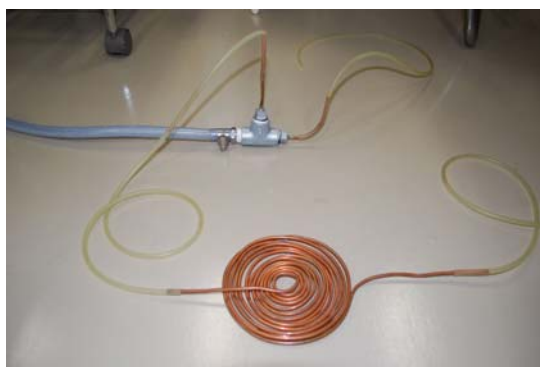
図 23 冷却路の様子 (2本のラインに分岐する場合 穴あきめくら栓にパイプを溶接)
