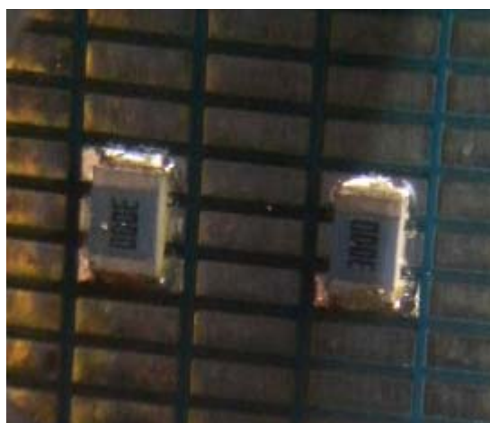
図 14. チップ部品の半田付けの様子
