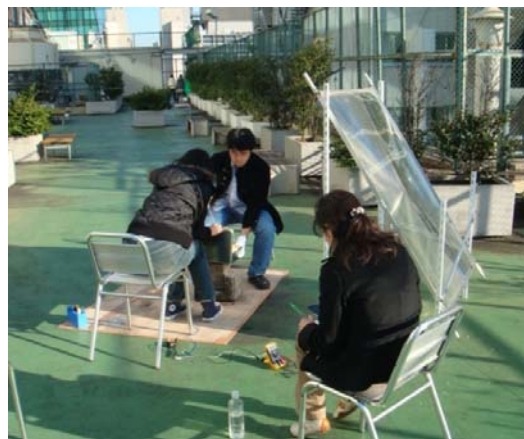
図B：フレネルレンズを用いた太陽光の集光実験（本文，図3.1より）：冬の傾いた日差しでも150W以上の仕事率が得られることがわかった。
