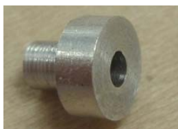
図 2.11 接続ピン(フライホイールーコンロッド間)
