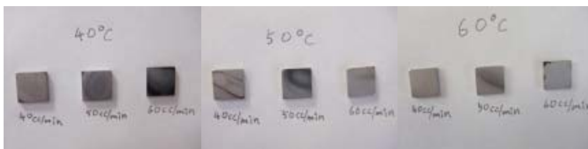
図 5 アルコール試料の温度 40, 50, 60 で水素流量を変化させた基板
