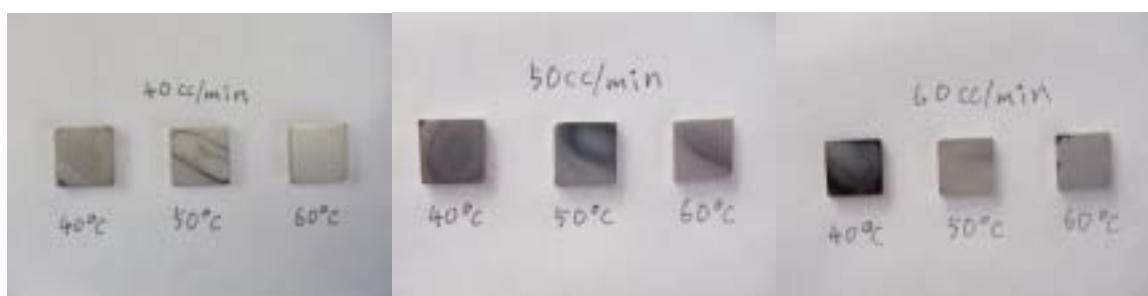
図 6 水素流量 40, 50, 60cc/min でアルコール温度を変化させた基板
