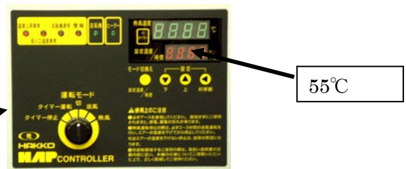
図 7 コントローラー操作パネル
