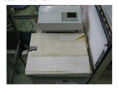
ブラインがホースやクーラーを流れることによる熱損失が生じることを考慮し,希望の冷凍室温度より若干低めに設定します.
