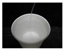
実験で用いるチューブは内径が細く,水を含ませるのが困難です. そこでチューブの先を水に浸け直接吸い上げることで,チューブ内に水を含ませます.極力チューブの端から端まで水が含まれるようにします.
