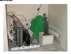
冷凍室内に植物,コップの水,チューブを入れたのち冷凍室の蓋をし,冷凍機のブラインを流します.レコーダーに表示される冷凍室内温度に注意しつつ,そのまま3時間放置します.
