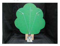
左の写真のようにボードにチューブを貼り付け, 固定します.チューブの下端は水漏れがないよう, 圧着しておきます.簡易的にチューブの所々をテ ープで固定しました.
