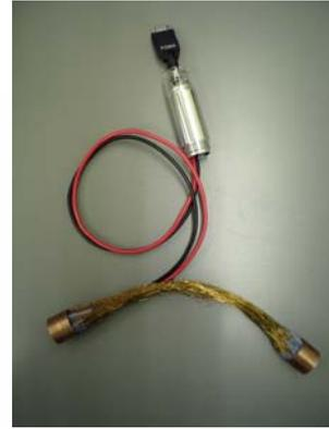
図 6 線状熱電発電ブロック（3号機）
