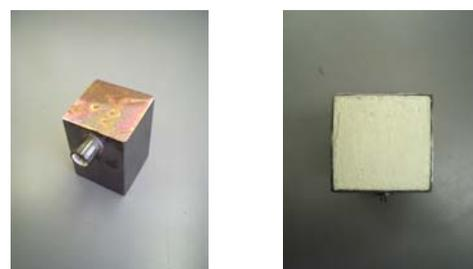
図3 四角状熱電発電ブロック (1号機)
