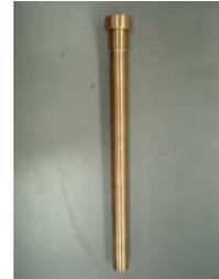
図 7 線状熱電発電ブロックの加熱部分
