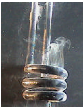
(a) ヒーター全体にコンデンスミルクを塗布した場合
