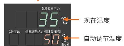
设定值显示器上交替显示「At.1」与「设定温度」。
