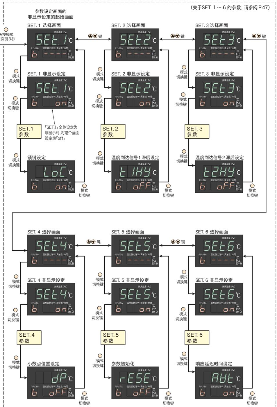
非显示设定画面移至运行模式画面时，请长按模式切换键5秒以上，或将电源关闭，重新启动。
