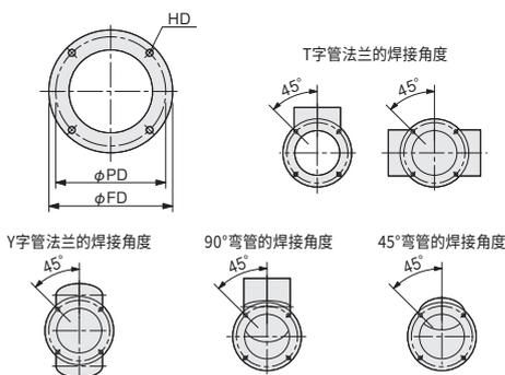
承接各种连接管的法兰焊接。请指定连接管种类、焊接位置、焊接法兰的个数。关于法兰的尺寸、以及T字管、Y字管、90°弯管、45°弯管的焊接角度如下图所示。
