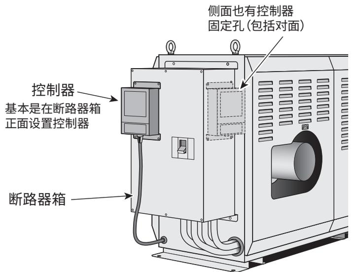
(2) 请将电源电线连接到本体设置的断路器上。
