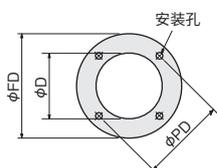
PPZ型: 非石棉密封圈 厚度 1.5 mm (耐热温度: 300°C)
