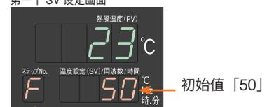
第一个 SV 设定画面显示「F」。与 SET.P 程序基本设定的第一个 SV 设定连动。
