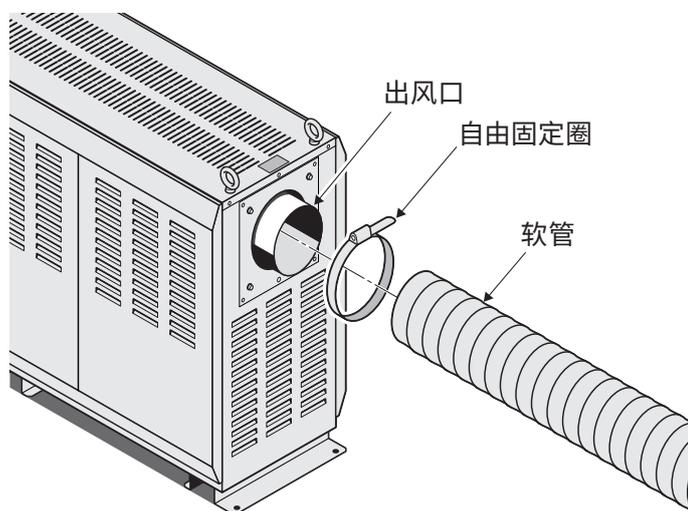
(2) 采用循环方式时，请将配件部品的「软管固定配件」或者「带法兰调节阀」安装到进风口，插入软管后用「自由固定圈」固定牢固。
