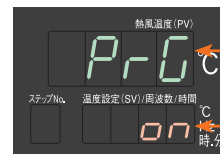
プログラム運転有効設定「on」の時の 運転モード画面の先頭画面
