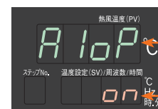
温度調節異常1の自己保持設定 本体吐出口の熱電対に対応
