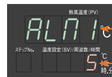
温度調節異常1の警報タイプ: 本体吐出口の熱電対に対応
