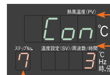
運転状態設定画面のコード 「3」で最終ステップの設定
