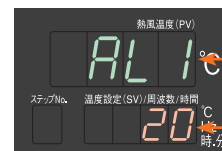
温度調節異常1の動作値設定 本体吐出口の熱電対に対応
