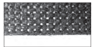
ヒートカットによる切断 切断面が溶けてぼつれない
