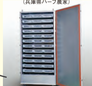
熱源 熱風発生機 1台 処理量 30kg
