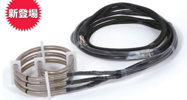
ヒーターシース：SUS304+フッ素樹脂0.3mm (PFA) 電源電線：3芯PVCコード3本（端子側で三相に結線）
