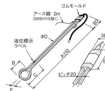
ヒーターシース：SUS316L (ステンレス) 電解研磨
