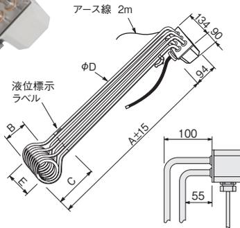
ヒーターシース : SUS316L (ステンレス) 電解研磨
