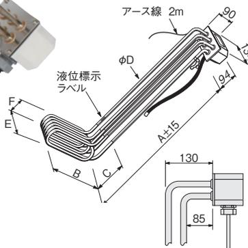
ヒーターシース : SUS316L (ステンレス) 電解研磨
