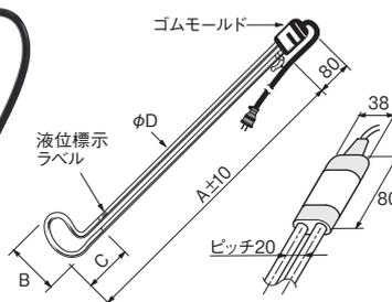
ヒーターシース：SUS316L (ステンレス) 電解研磨
