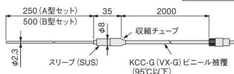
シース材質 : SUS316相当 测温接点 : 非接地形 許容差 : クラス2
